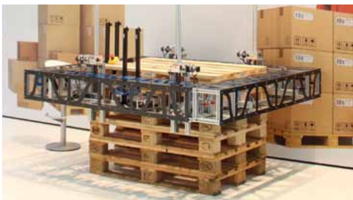
Der Tagging-Roboter bestückt beim Hinaufklettern des Stapels jede Palette mit zwei RFID-Transpondern.
