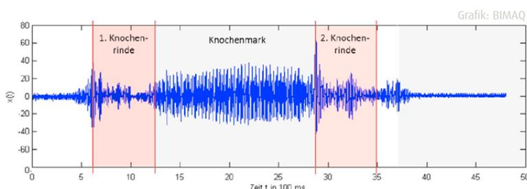
Mittels Körperschallsensor erfasste Schwingungen während der Bohrung durch den Knochen
