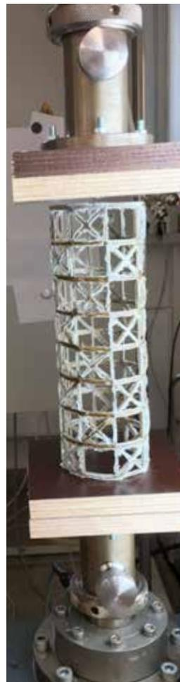
Filigrane Struktur mit einem Durchmesser von 50 mm, die mit dem neuartigen Kern gewickelt wurde.
